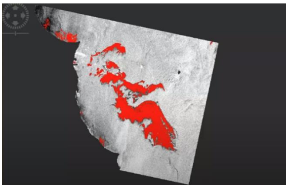
نمایش آلودگی نفتی با رنگ قرمز پس از پردازش تصویر سنتینل ۱ و فیلتر کردن خشکی ها در سیستم تصویر UTM
