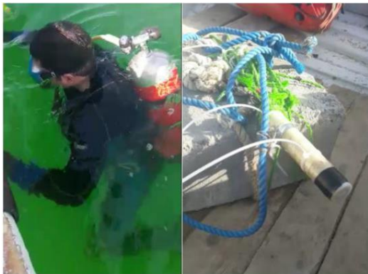
نصب RBR جهت انجام مطالعات ۳۰ روزه جریان و تراز سطح آب در محل احداث آب شیرین کن کوه مبارک
