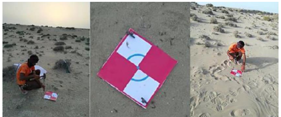
پیاده سازی تارگت های مربوط به نقاط کنترل و چک زمینی در پروژه برداشت توپوگرافی سایت نیروگاه حرارتی سیریک
