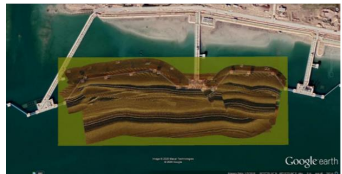
مجموعه تصاویر برداشت شده ساید اسکن سونار در پروژه بندر صادراتی ماهشهر
