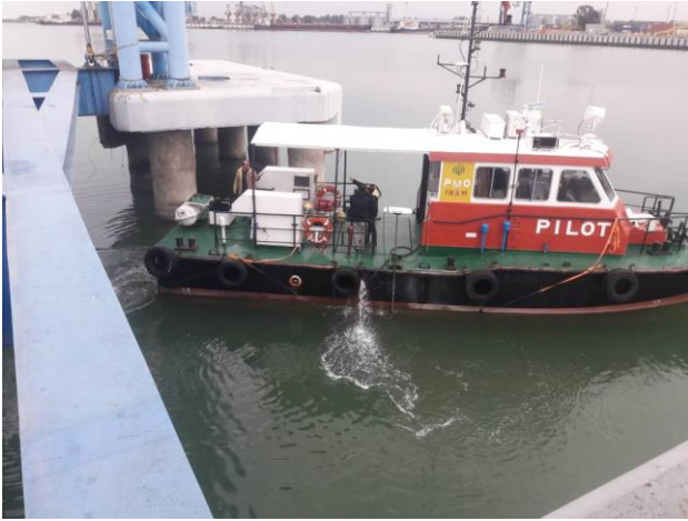
انجام عملیات هیدروگرافی Multi Beam (بندر امیرآباد)
