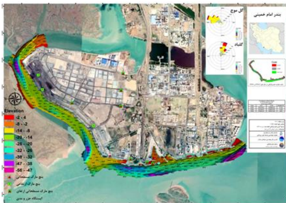
نمونه ای از نقشه های هیدروگرافی سینگل بیم تهیه شده در بنادر استان خوزستان و بوشهر (کارفرما: سازمان بنادر و دریانوردی ۹۶-۹۷ و ۹۷-۹۸)
