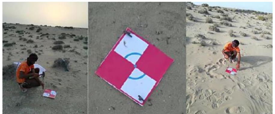
پیااده سازی تارگت های مربوط به نقاط کنترل و چک زمینی در پروژه برداشت توپوگرافی سایت نیروگاه حرارتی سیریک
