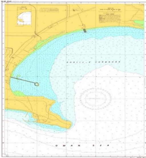
چارت دریایی ۱:۵۰۰۰۰ تهیه شده در پروژه پایش سواحل مکران به روش هیدروگرافی سینگل بیم
