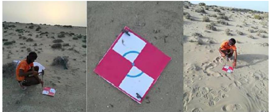
پایه سازی تارگت های مربوط به نقاط کنترل و چک زمینی در پروژه برداشت توپوگرافی سایت نیروگاه حرارتی سیریک
