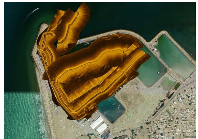
مجموعه تصاویر برداشت شده ساید اسکن سونار در پروژه اسکله جاسک
