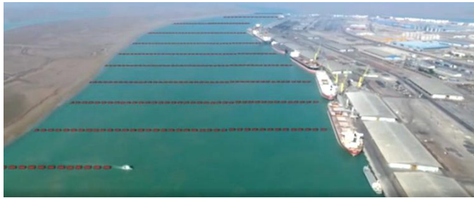
تصویر خطوط هیدروگرافی در عملیات برداشت Multi Beam بندر امام خمینی (ره)
