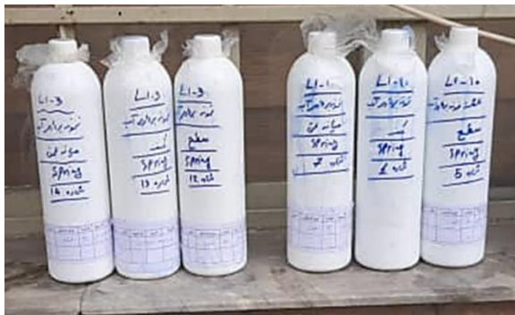
برداشت نمونه آب در دوره زمانی مهکشد در ۳ عمق متمایز و دو نقطه مختلف نزدیک ساحل و دور از ساحل جهت تهیه پروفیل غلظت رسوب معلق در محل احداث آب شیرین کن کوه مبارک
